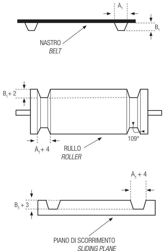
Le forze di spinta laterale possono essere controllate saldando sul nastro profili longitudinali di guida.
